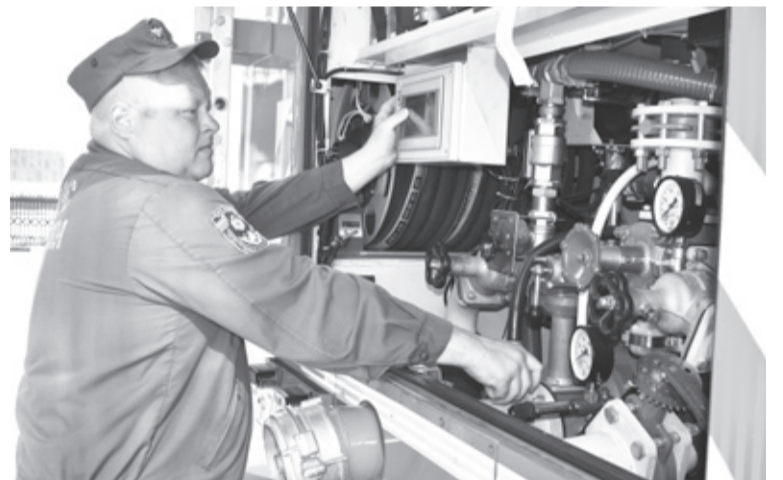
Водитель Анатолий Рожков проводит проверку исправности насоса пожарного автомобиля. Когда работники заступают на смену, начинается приёмка техники, заправочных ёмкостей, горюче-смазочной жидкости, воды, пенообразователя, всех огнетушащих веществ. Фото автора
